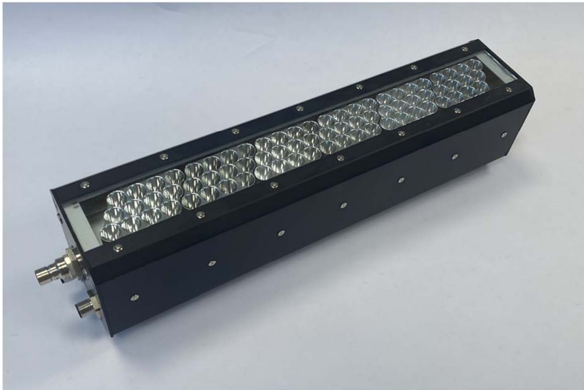
Abb. 8: Demonstrator eines wassergekühlten LED- Strahlers für 72 LEDs der Baureihe OCU-480 oder OMC-747. Dieser Strahler wurde ursprünglich für den Einsatz von UVA- LED entwickelt, ist jedoch für Breitband- LEDs ebenso einsetzbar.
